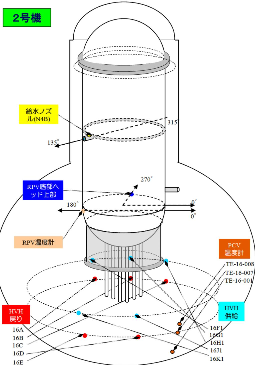
2号機 原子炉压力容器まわり温度(7/1~9/30)
