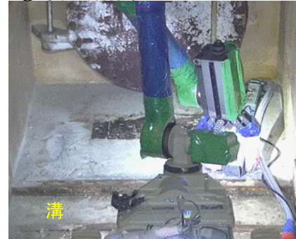
Warriorに小型研削機を把持させ床面を研削
