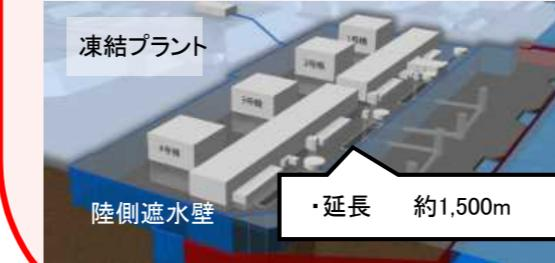
建屋への地下水流入を抑制するため、建屋を囲む陸側遮水壁の設置を計画。2014/6/2から凍結管の設置工事を実施し、2016/2に凍結設備の工事完了。2016/3より凍結を開始。
