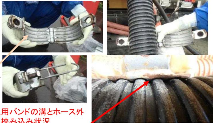
締込用バンドの溝とホース外面の挟み込み状況
