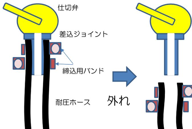
耐圧ホースが締込バンドごと外れ、ホース内の内包水はアスファルト面に漏えいした。（ホース内は吸引作業中は負圧となっている。）
