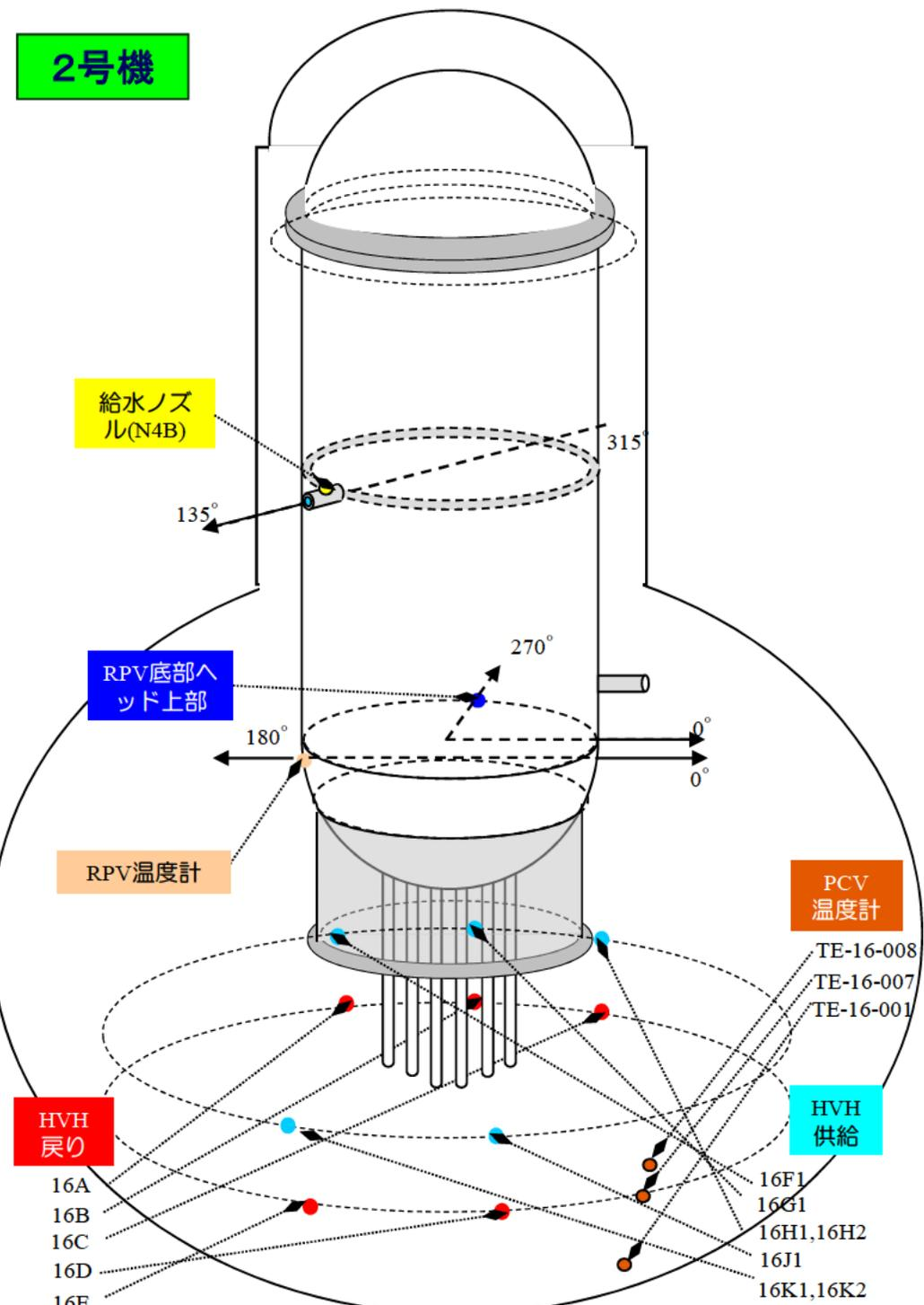
2号機 原子炉压力容器まわり温度 (10/26~1/27)
