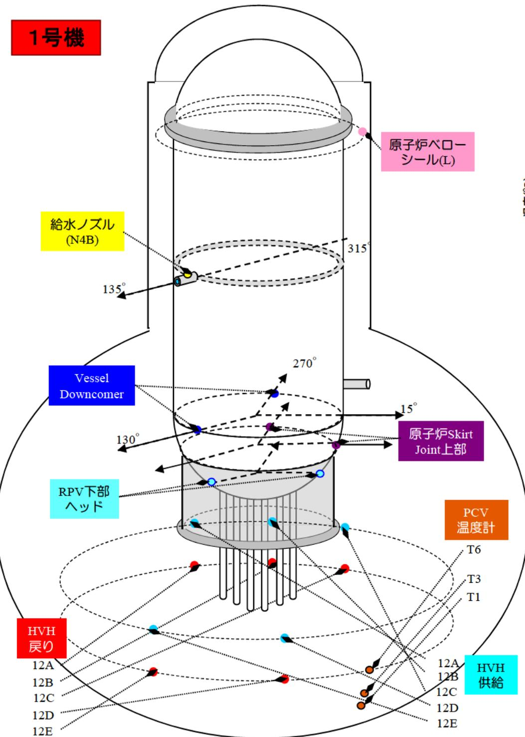
1号機 原子炉压力容器まわり温度(10/26~1/27)
