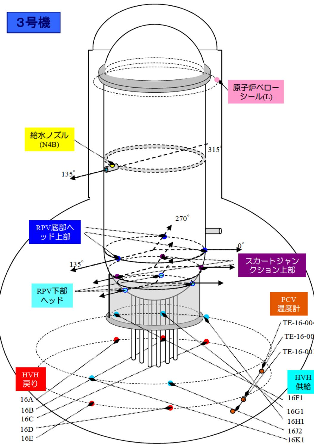
3号機 原子炉压力容器まわり温度(10/26~1/27)
