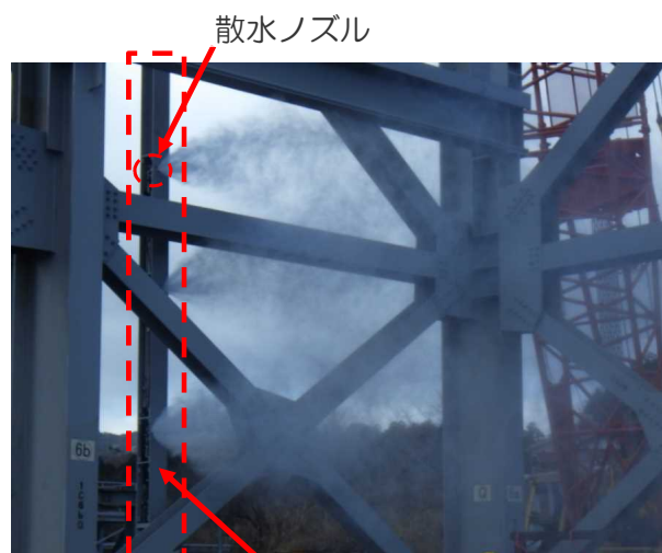
ノズルユニット 散水設備モックアップ状況写真 （構外ヤード）
