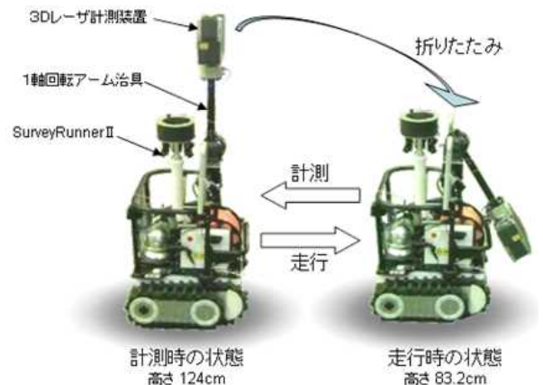
計測装置を搭載した遠隔操作装置の外観
