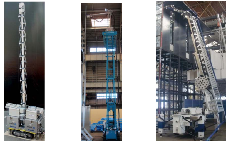
高圧水ジェット ドライアイスブラスト 吸引・ブラスト 図1 高所用除染装置
