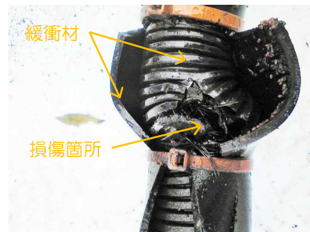
作動油ホースの損傷状況
