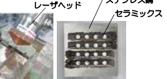
図5 燃料デブリの切削性能試験
