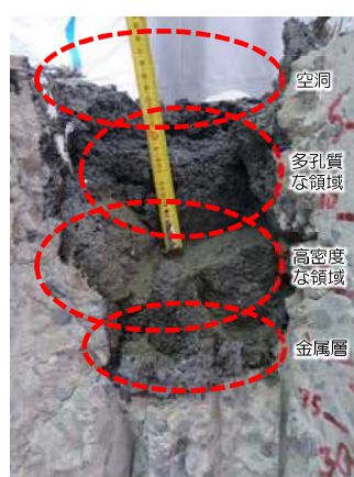
図1 仏国CEAとの協力により作製した大型MCCI試験生成物の様子
