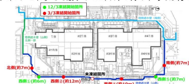
図2：陸側遮水壁（山側）の一部閉合箇所
