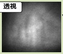
✓ 圧力容器の炉心部には燃料なし（推定）
