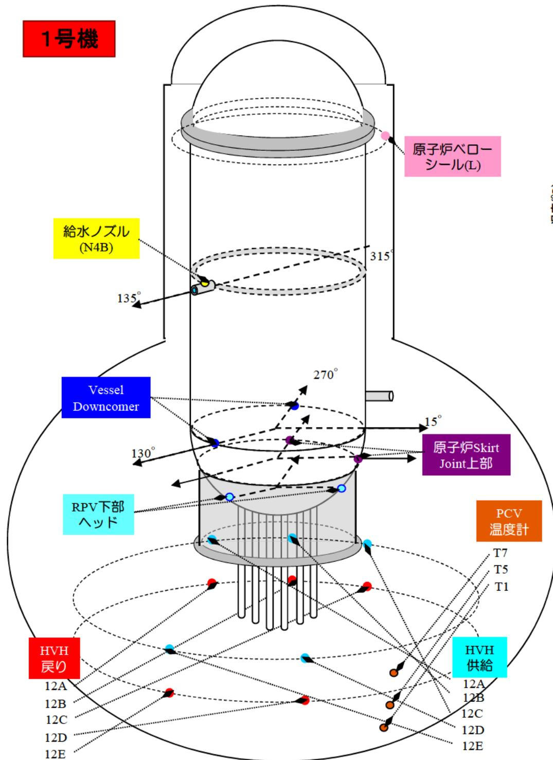
1号機 原子炉圧力容器まわり温度(8/26~12/20)
