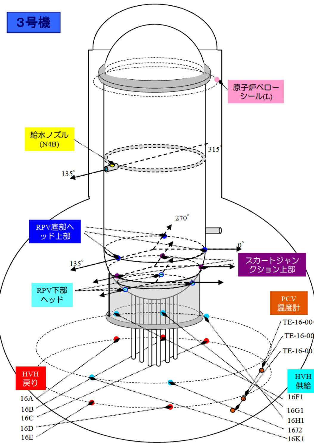
3号機 原子炉圧力容器まわり温度(8/26~12/24)
