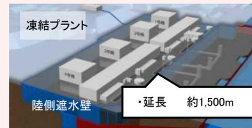
建屋への地下水流入を抑制するため、建屋を囲む陸側遮水壁の設置を計画。
