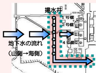
山側から流れてきた地下水を建屋の上流で揚水し、建屋内への地下水流入量を抑制する取組（地下水パイパス）を実施。
