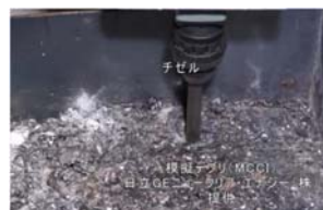
図1 チゼル加工予備試験状況
