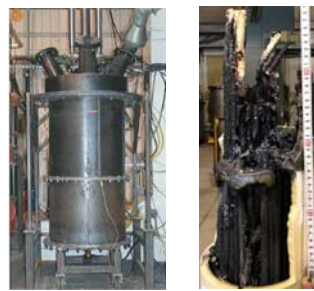
図3 模擬燃料集合体プラズマ加熱試験
