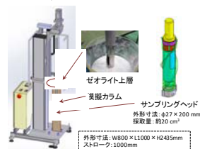
図3 セシウム吸着塔吸着材の採取試験装置
