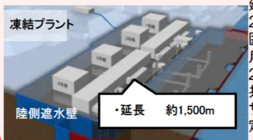
建屋への地下水流入を抑制するため、建屋を囲む陸側遮水壁の設置を計画。
