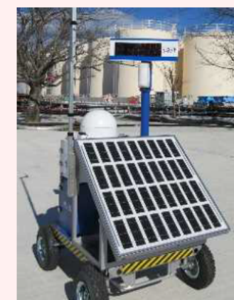
線量率モニタの設置状況
