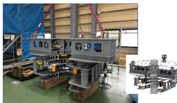
鉄塔解体装置（主柱材用）組立状況
