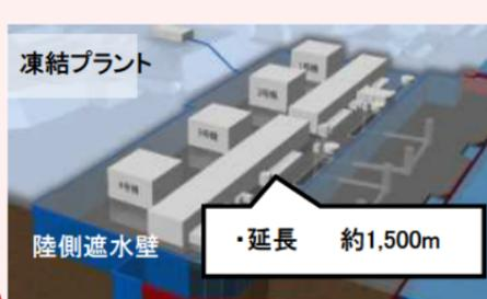
建屋への地下水流入を抑制するため、建屋を囲む陸側遮水壁の設置を計画。
