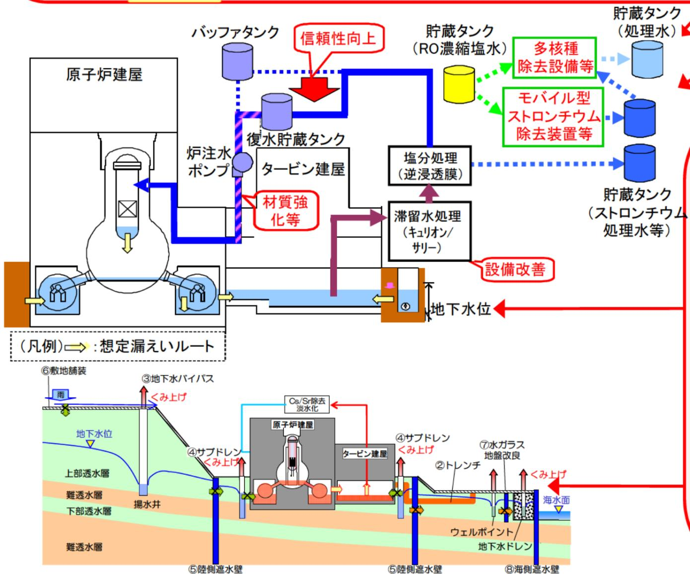
原子炉建屋への地下水流入抑制
