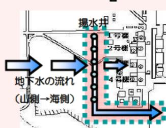
地下水バイパスにより、建屋付近の地下水位を低下させ、建屋への地下水流入を抑制
