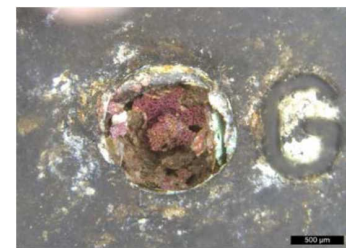
⑥断線部拡大 (清掃後)
