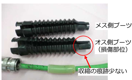
②ブーツの熱収縮状況
