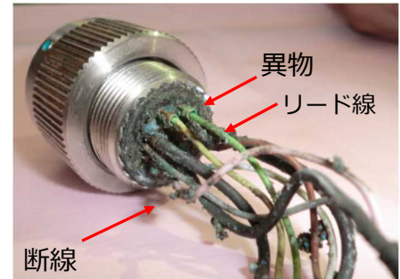
分解後 (オス側、断線・異物確認)
