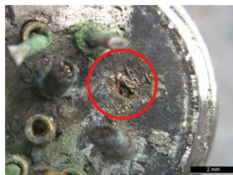
④断線部拡大 (異物除去後)
