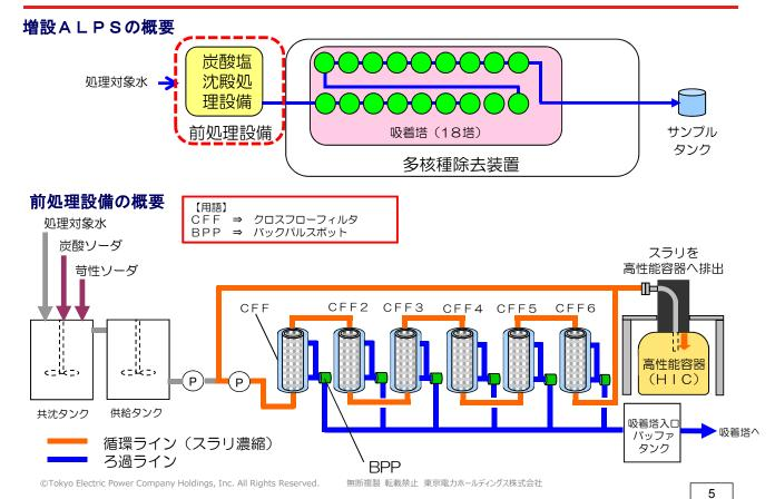
逆洗時は、エア駆動によりピストンが動作CFFへ逆圧を負荷する。
