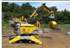
BROKK400D 主な役割 ・Warriorの移動 ・フェンスの切断・片付等
