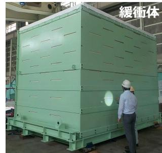
寸法：約3.4m×約5.1m、高さ約5m（車両込）
