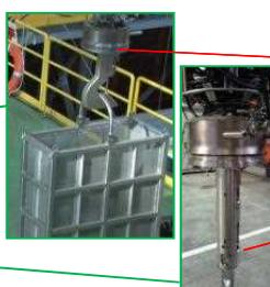
補助ホイスト先端にフック形状のツールを接続し、バスケットを吊り下げる、マニピュレータでつかんだがれきを回収
