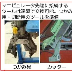
マニピュレータ先端に接続するツールは遠隔で交換可能。つかみ用・切断用のツールを準備
