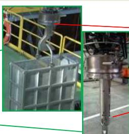
補助ホイスト先端にフック形状のツールを接続し、バスケットを吊り下げて、マニピュレータでつかんだガレキを回収
