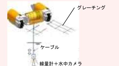
線量計、カメラ吊り降ろしイメージ
