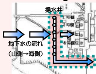
山側から流れてきた地下水を建屋の上流で揚水し、建屋内への地下水流入量を抑制する取組（地下水バイパス）を実施。
