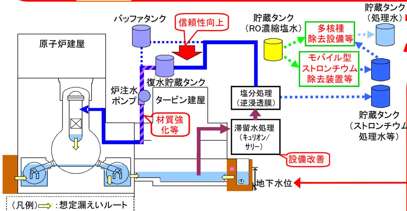
原子炉建屋への地下水流入抑制
