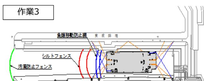
開渠内南側へ船上のウインチとシンカーブロックを移動用ワイヤーで繋ぎ、引っ張りながら移動させ、最終的には開渠南側に係留します。
