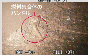
2号機内部調査では燃料デブリと推定される堆積物を確認
