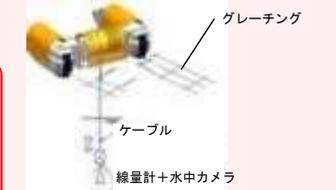
線量計、カメラ吊り降ろしイメージ
