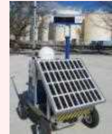
線量率モニタの設置状況
