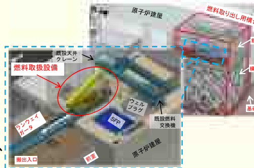
燃料取り出し用構台及び燃料取扱設備概念図
