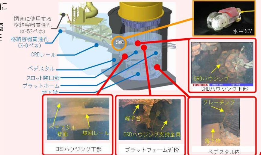
ペDESTAL内部の状況
