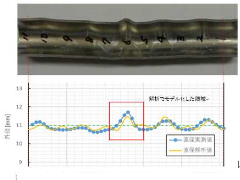
曲げ戻し後の被覆管断面と外径プロファイル
