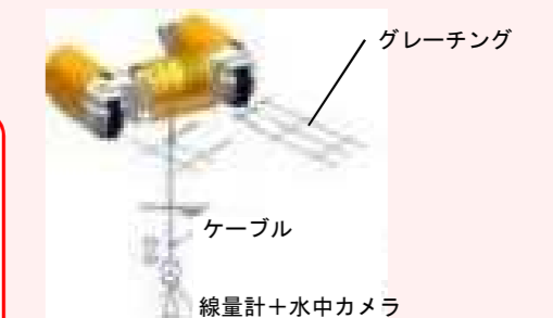
線量計、カメラ吊り降ろしイメージ
