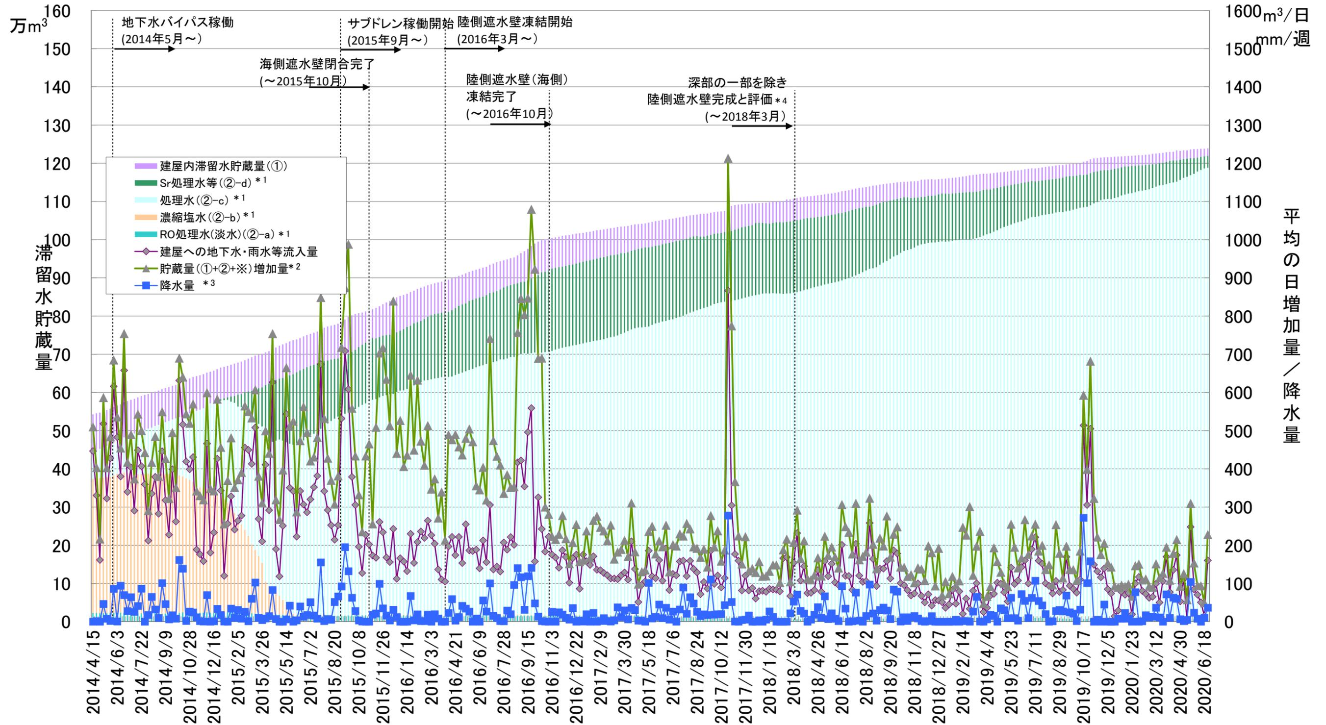
①: 建屋内滞留水貯蔵量(1~4号機、プロセス主建屋、高温焼却炉建屋、廃液供給タンク、SPT(B))
