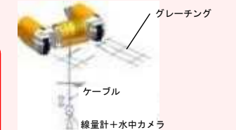
線量計、カメラ吊り降ろしイメージ
