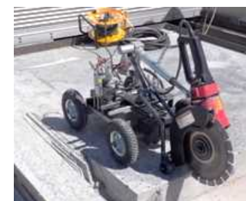
溝切ロボット(モックアップ機)
