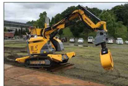
遠隔無人重機（BROKK）
