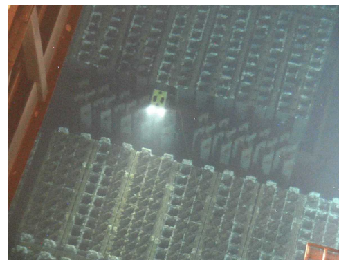
2号SFP内での水中ROV走行の様子
