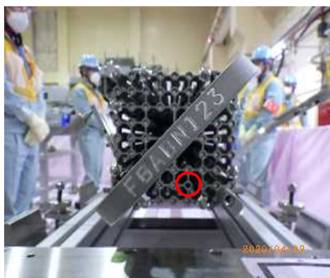
上部タイプレートの取り付け
