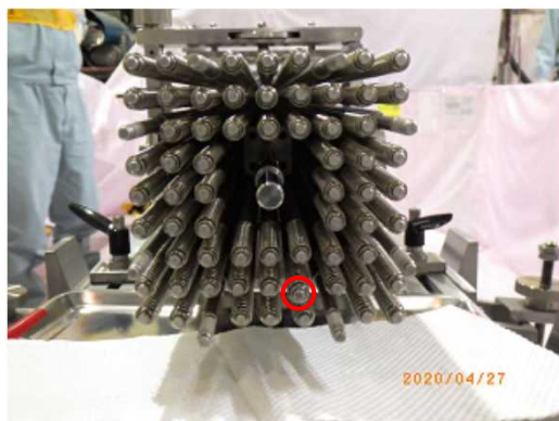
挿入後の曲げ戻し燃料棒
