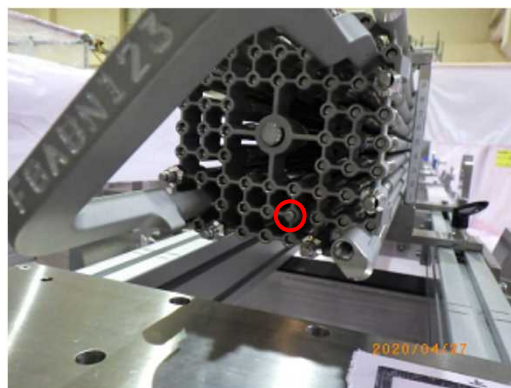
上部タイプレート取り付け
