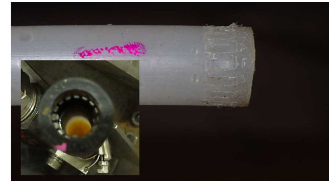
ジョイント部から引っ張られた痕
