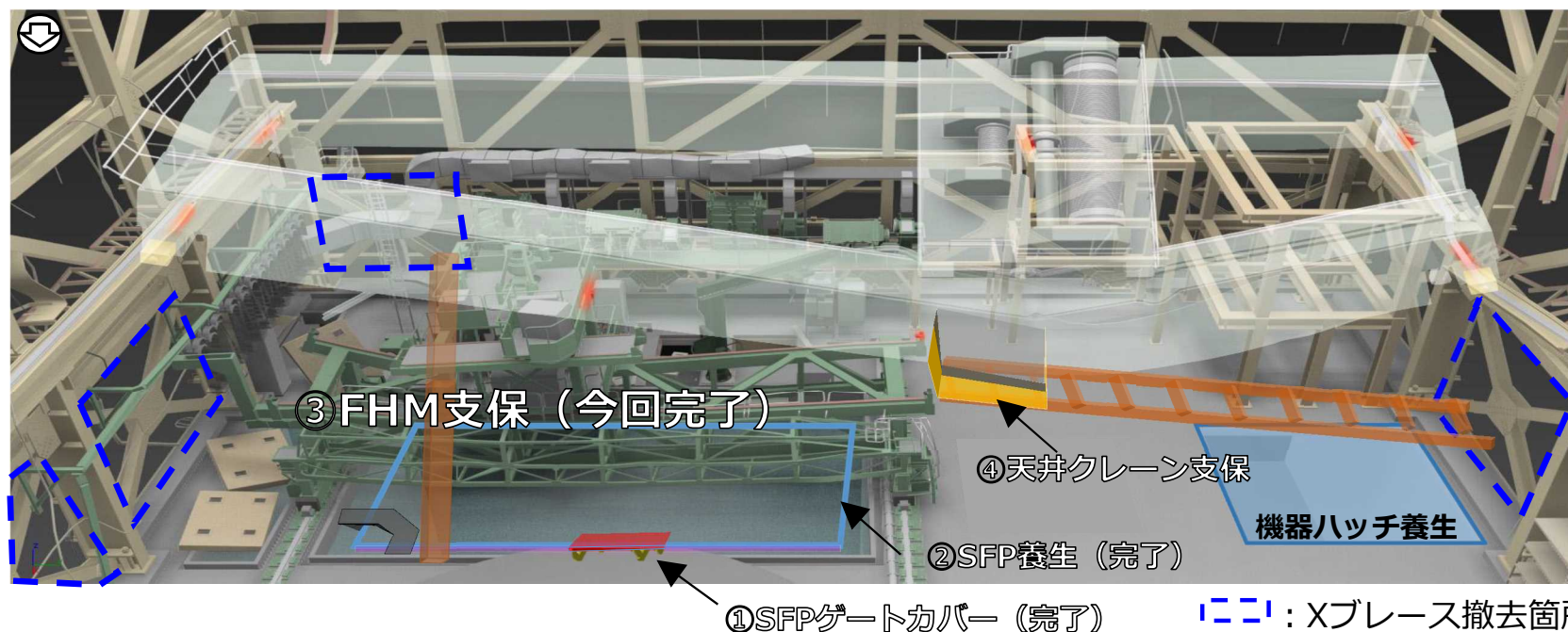
図：ガレキ落下防止・緩和対策の概要
