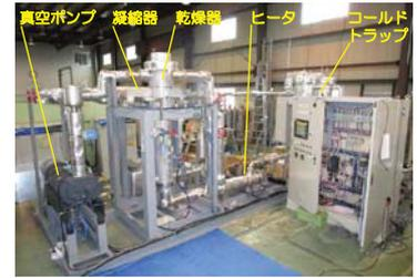
図5 乾燥試験装置
