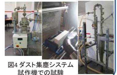
図4 ダスト集塵システム試作機での試験
