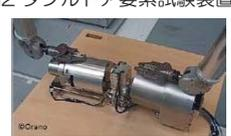
図5 燃料デブリ回収装置 (フレキシブルグリッパ型)
