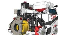
図6 燃料デブリ収納容器の遠隔輸送台車
