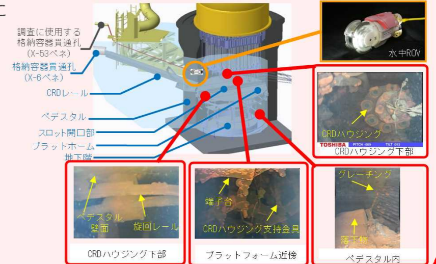
ペDESTAL内部の状況
