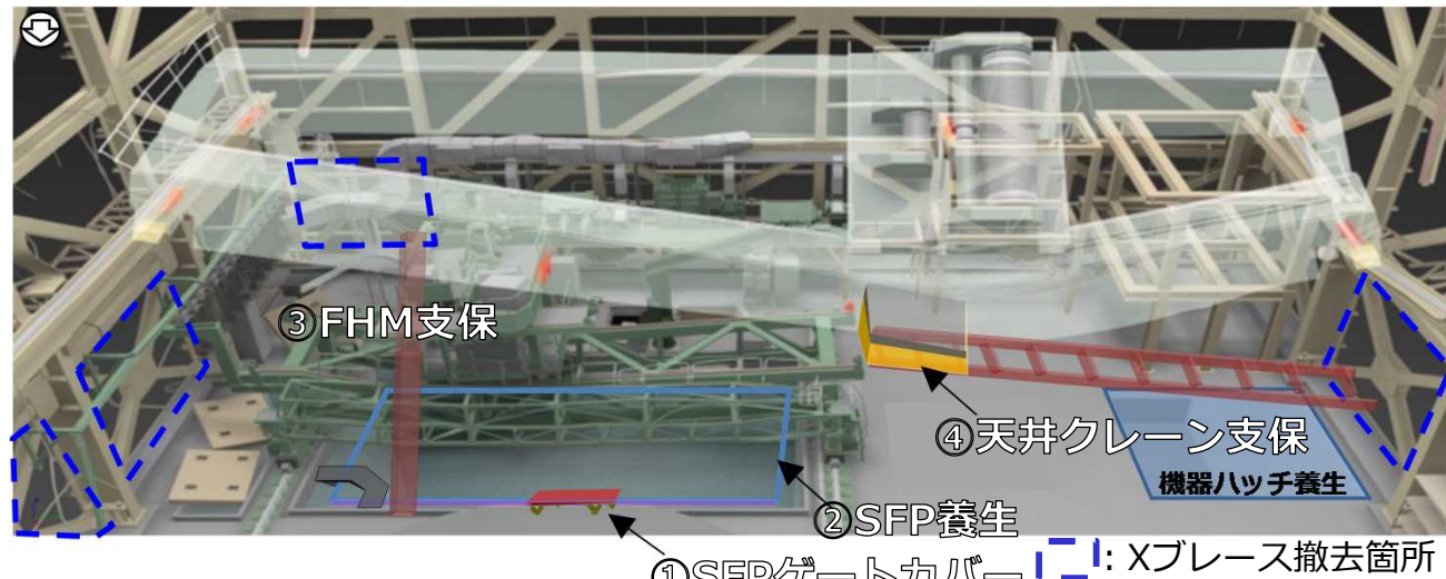
1号ガレキ落下防止・緩和対策
