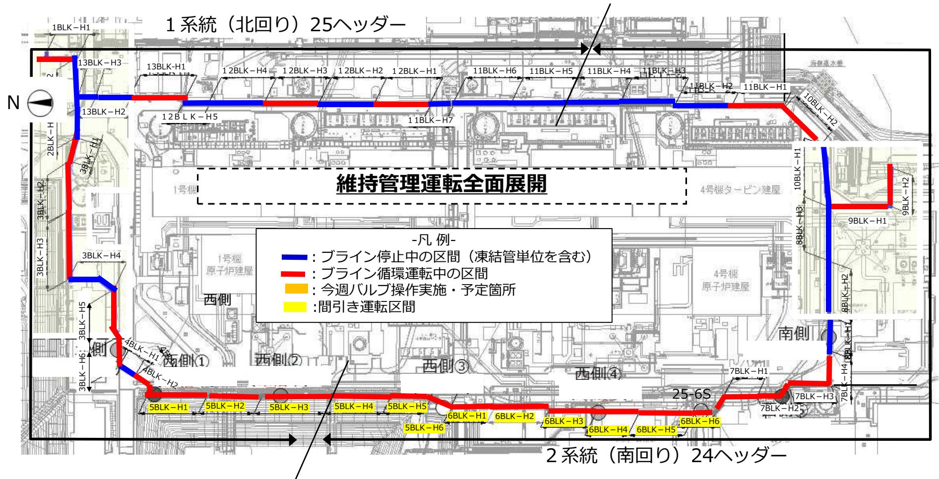
※ 全測温点-5℃以下かつ全測温点平均で地中温度-10℃以下でブライン循環を停止。ブライン停止後、測温点のうちいずれか1点で地中温度-2℃以上となつた場合はブラインを再循環。なお、これら基準値は、データを蓄積して見直しを行っていく。
