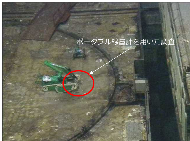
測定点⑩における床面測定状況
