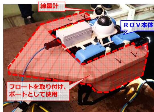
調査に使用するボート型ROV
