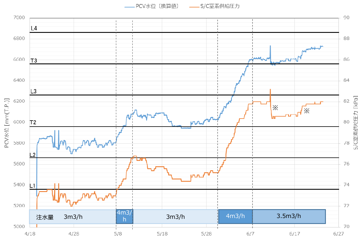
1号機 新設した圧力計によるPCV水位評価
