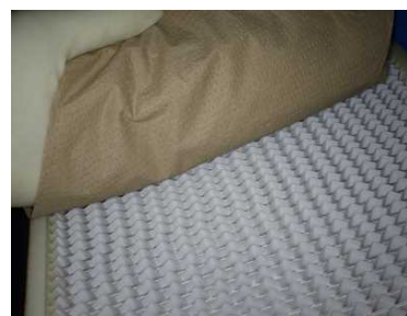
HEPAフィルタには 水滴なし・破損無し
