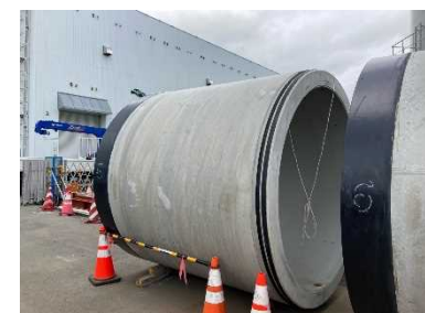
推進管（内径2,200 外径2,568）
