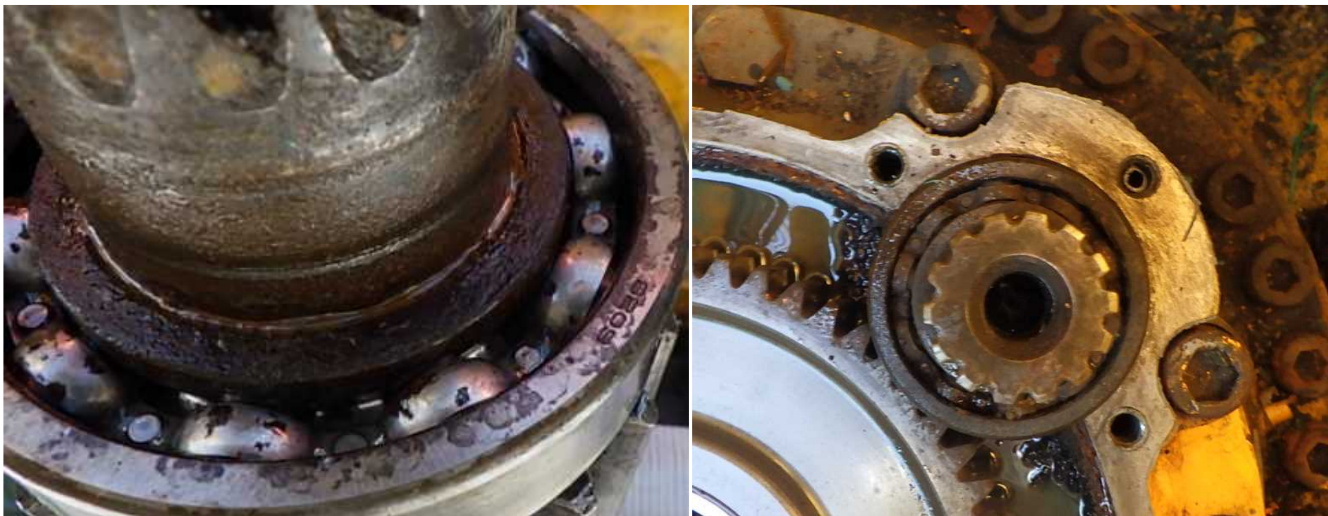
異音を確認した、ベアリングの分解状況
